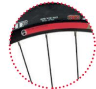
Das Mixed-Wheel-Konzept sorgt vorne mit 29" für Laufruhe und Spurtreue, während das Heck mit 27,5" bessere Beschleunigung erzielt.
