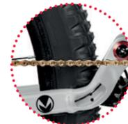
KMC X12 Ti-N-Kette mit goldfarbener Titan-Nitrit-Beschichtung für präzise Schaltvorgänge mit hoher Langlebigkeit.
